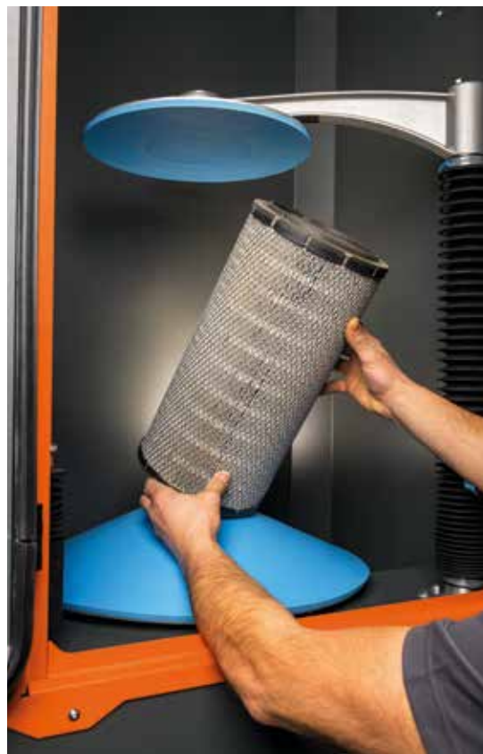
Mit der Luftfilter-Reinigungsanlage lassen sich sowohl zylindrische als auch konische Rundfilter von trockenen Stäuben reinigen. Bilder: Synex Tech
